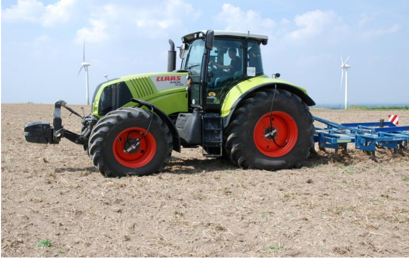
Bodenschutztraktor mit Reifendruckregelanlage und 3D-Bildverarbeitung der Fachhochschule Südwestfalen, Fachbereich Agrarwirtschaft Soest.
