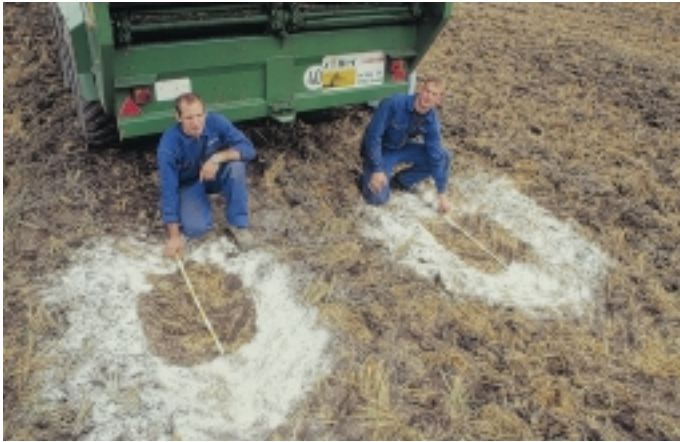
Radiale Anhängerreifen bei der Aufstandsflächenmessung mit Mehl
