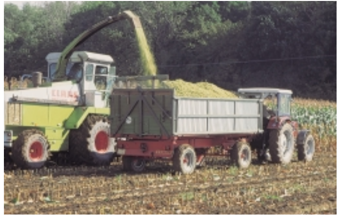
Bei der Ernte sind die Anhängerreifen mit hohem Luftdruck von über 3 bar besonders bodenschädlich. Während der Häcksler oder Drescher mit 2 bar fahren könnte sind die alten Transportwagen die Spurenerzeuger
