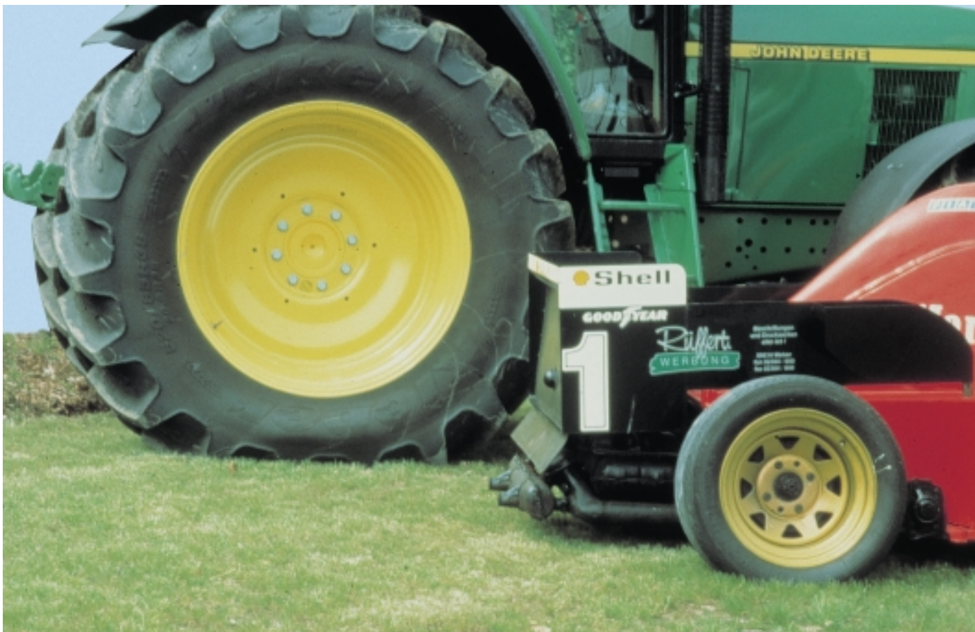
Ob Rennwagen oder Traktor: die Verbindung zwischen Fahrzeug und Fahrbahn ist der Reifen. Hohe Traktion, weniger Schlupf, gute Fahreigenschaften durch präzise Fertigung und lange Betriebsdauer sollte der Reifen bringen. Die Reifenwahl bestimmt Zugkraft und damit Nutzen des Traktors.
