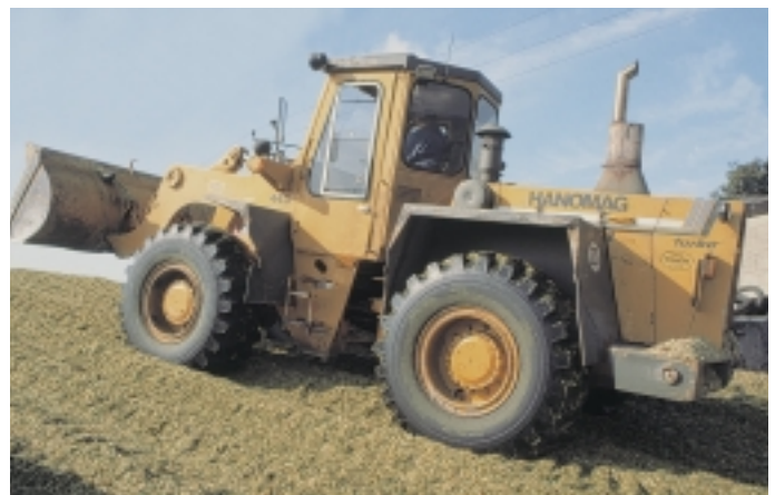
Hohe Maschinenmasse beim Radlader von 15 Tonnen und harte Reifen mit 4 bar verdichten besser und sollten bei den großen Erntemengen zur Qualitätserhaltung genutzt werden (Fotos: Verfasser)
