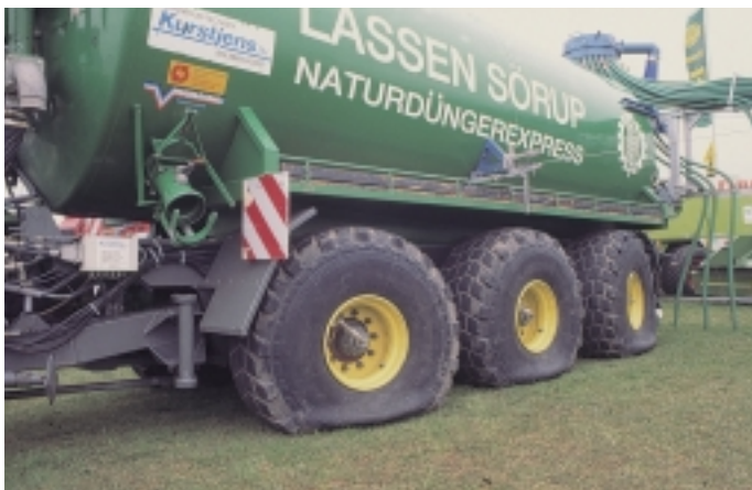
Gülle wird bodenschonend als flüssiger Volldünger ausgebracht. Mit einem Reifenregler und 1 bar Reifendruck auf dem Acker und 4 bar auf der Straße wird Diesel gespart und Spuren vermindert
