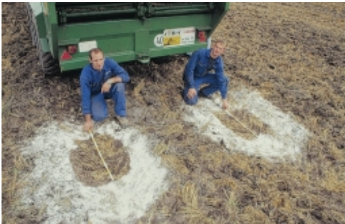
Radiale Anhängerreifen bei der Aufstandsflächenmessung mit Mehl
